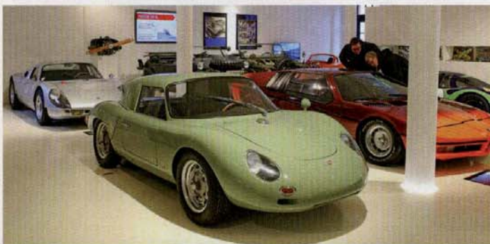
Denna Wendler-Porsche av typ W/RS från 1960 är riktigt vass trots sin relativt beskedliga motor. 1.498-kubikaren på 135 hk ger 228 km/tim i toppfart. Hemligheten är den låga vikten på 650 kg.
