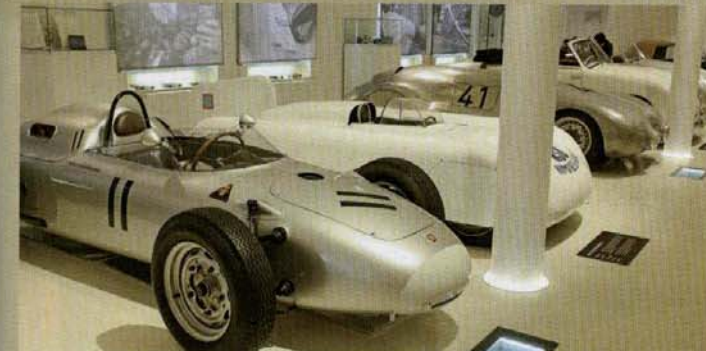
I förgrunden en Porsche 718/2 byggd 1960. Vikt 465 kg, toppfart 280 km/tim. Bakom den en NSU Weltrekordwagen som slog fyra hastighetsrekord på autobahn München-Ingolstadt 1951. 500 kubik, 110 hk, 290 kg.
